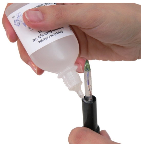
Uzupełnianie elektrolitu żelowego w kołnierzu elektrody
